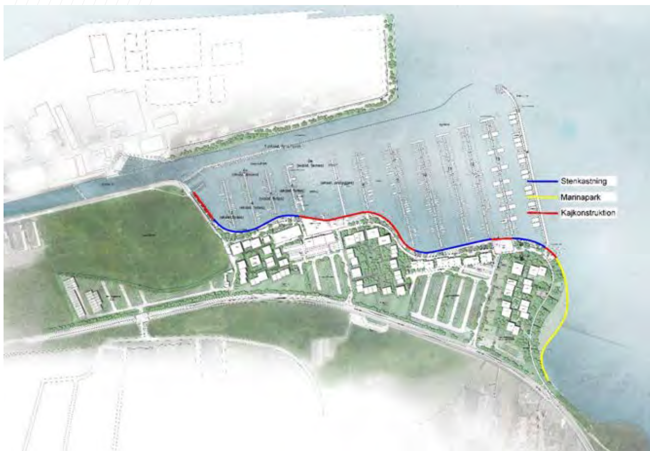
Figur 3-6: Optimeret havnelayout med angivelse af beliggenhed af anlægselementer. Detaljerede kortudsnit i høj opløsning kan ses i bilag 14.
