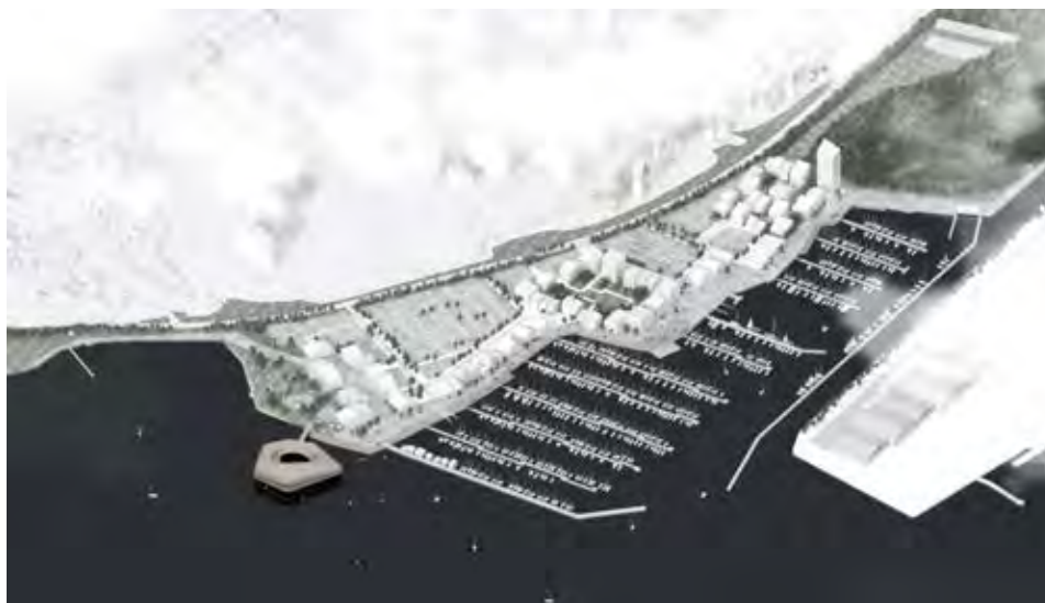
Figur 2-7: Aksonometri af det i 2017 ændrede projekt illustrerende flytningen af høj bebyggelse, reduktion i østlig udbredelse og i antallet af øer samt vinteroplag mm. mod vest.
