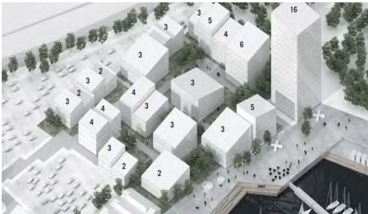
Figur 5-15: Princip forfordeling af bygningsmassen i område B, Skovboligerne (Marina City, 2017), der kan illustrere udnyttelsen af delområde 6 (lokalplan 0042-21, 2019).
